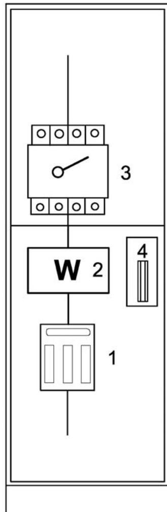
Bild 2: Wandlerschrank für Innenraumwandlermessung bis 1000 A
