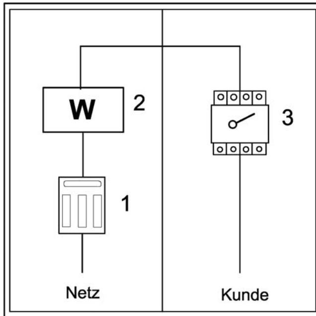
Bild 1: Wandlerschrank für Innenraumwandlermessung bis 400 A
