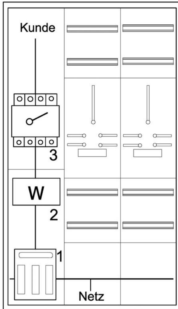
Bild 3: Wandlermessung bis 250 A anreihbar für Direktmessung
